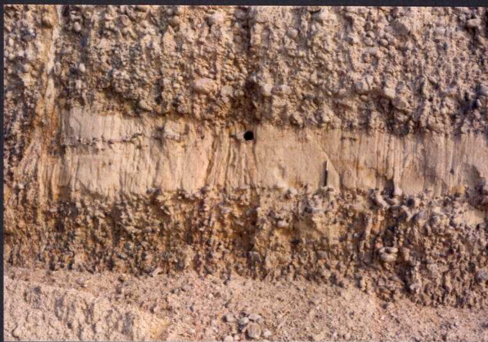
Foto 13.- Explotación 29-17 en Monte Enguilu (Nava) en conglomerados del Cretácico inferior. Intercalación arenosa dentro del conglomerado de 30 cm de potencia.
