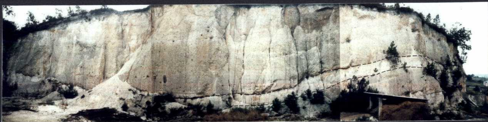
Foto 11.- Explotación 29-75 en La Secada (Siero) en conglomerados del Cretácico inferior. En la parte basal se observa un nivel de arenisca blanca de 1 m de potencia.
